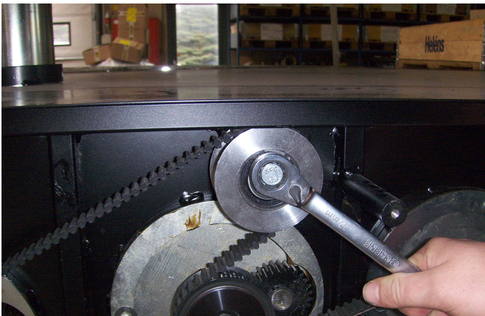
Billede P: Reversering af omløbsretning på slibehoved
