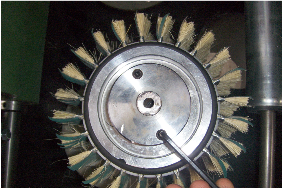
Billede H: Indstilling af de vandrette slibehoveder
