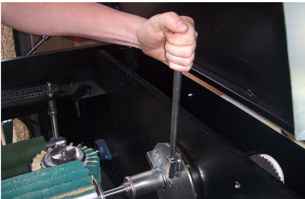
Billede H: Indstilling af de vandrette slibehoveder
