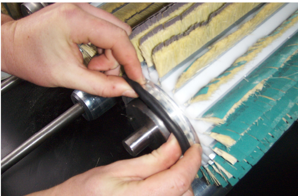
Billede L: Udskiftning af slibestrips
